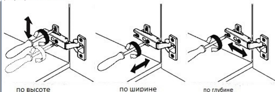
регулировка петель
